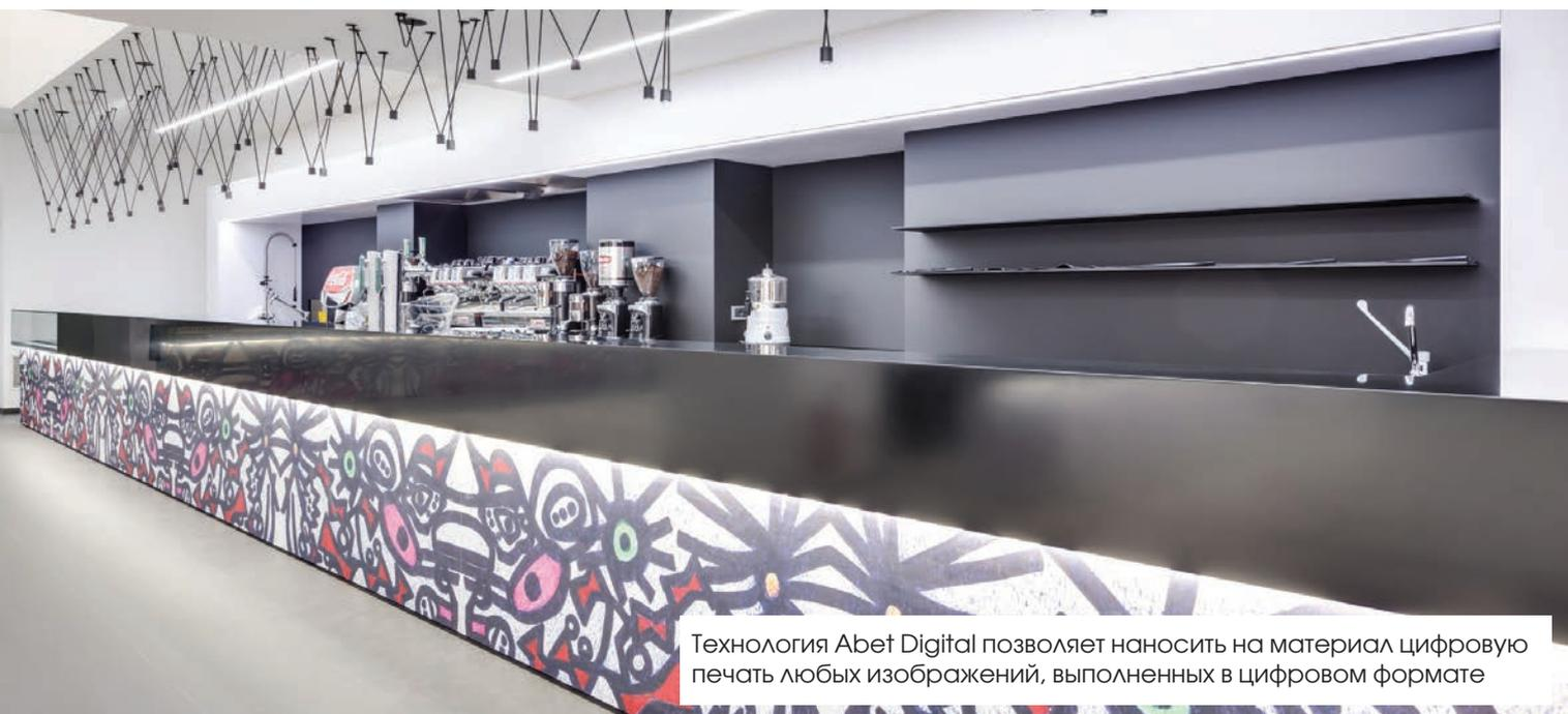
Технология Abet Digital позволяет наносить на материал цифровую печать любых изображений, выполненных в цифровом формате
